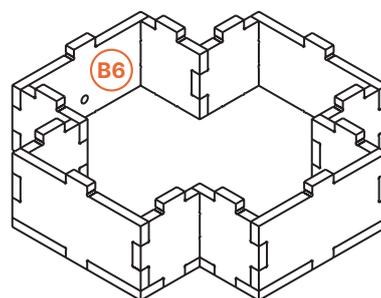
6. Passer l'extrémité femelle de la rallonge à travers l'ouverture de B6 en s'assurant que l'extrémité mâle reste à l'extérieur du socle.
